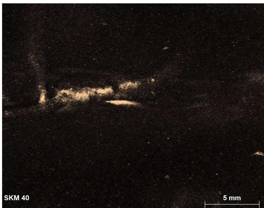
Die Strontiumgehalte sind in einem diffusen Bereich um die Klüfte stark erhöht. Es wird deshalb von Fluidmigration während der Diagenese ausgegangen. Die Klüfte hängen somit nicht mit der Präparation oder anderer mechanischer Einwirkung zusammen.
