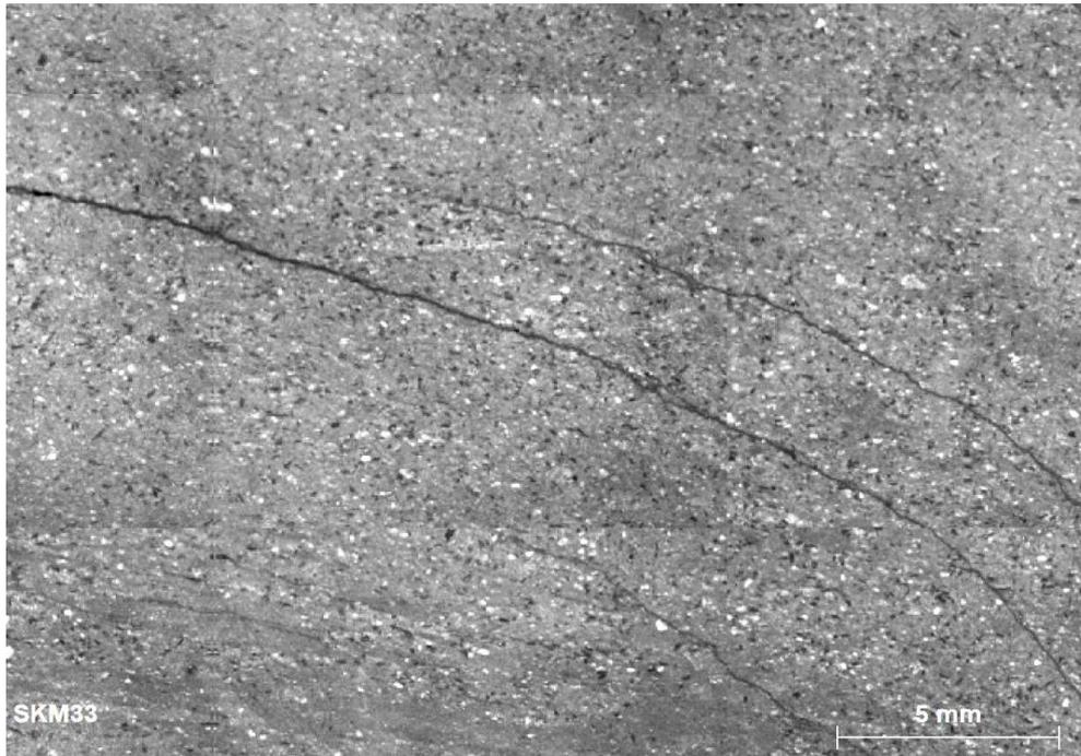
Die Probe des kalkig-sandigen Siltsteins zeigt im optischen Scan deutliche Risse, die dunkler erscheinen (offene Klüfte).
